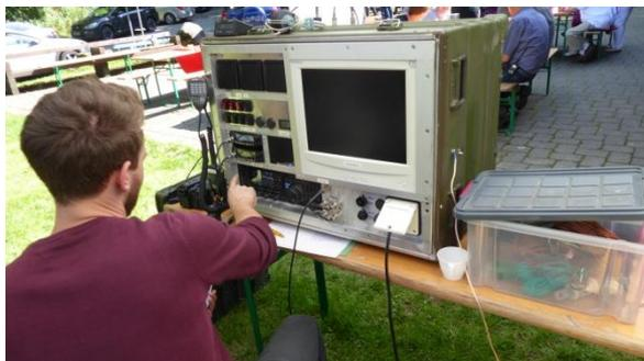
Durch die Möglichkeit beide Antennen anzuschließen, konnte man schön ausprobieren, welche Unterschiede beide Antennenformen haben. Zur Anpassung der Vertikalantenne diente der in der Station verbaute SGC-Tuner, das übernahm beim Dipol der interne Tuner des FT-1200DX.
